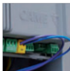
Wejście BUS obsługujące technologię CAME CXN BUS.
